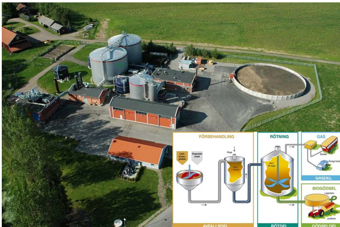
Figur 2 Flyfoto över biogasanläggningen i Linköping med principskiss över anläggningen.
